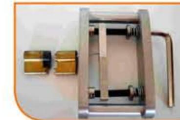
5- Enroscar con la llave allen nº 8 alternativamente y en sentido horario los dos tornillos de la parte posterior del extractor (como máximo dos vueltas y cambiar).
