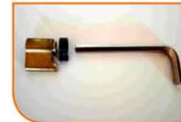
6- La llave posee un imán en el extremo largo, acercar al interior de la cerradura y extraer el eje central del interior.
