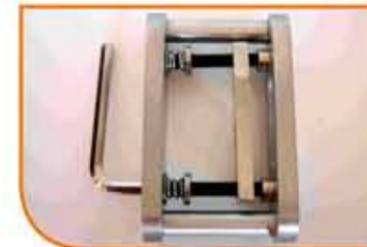
1- Enroscar con la llave allen de 8 mm alternativamente y en sentido antihorario los dos tornillos de la parte posterior del extractor de manera que la pletina interior se desplace hacia la parte delantera.
